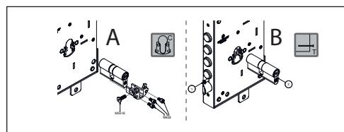
**10)** Non forzare l'inserimento del cilindro durante il montaggio.
